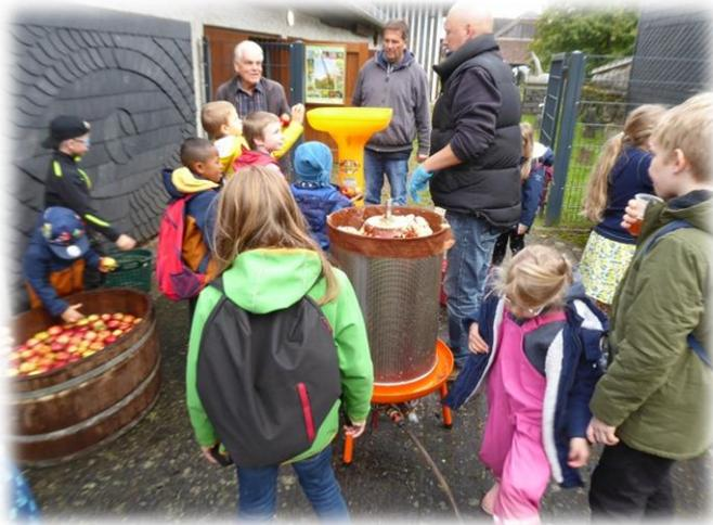
In dieser Mühle werden die Äpfel zu Mus verarbeitet und in einer Wanne aufgefangen. Das Apfelmus kommt danach in die Hydro-Press, die zuvor mit Tüchern ausgelegt wird. Mit einem Wasserdruck von ca. 3 bar wird der Saft aus dem Apfelmus gepresst. Der Apfelsaft floss dann durch ein Sieb in den Safteimer. Die
